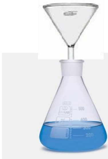
Fig. 2. Instalație de filtrare simplă
